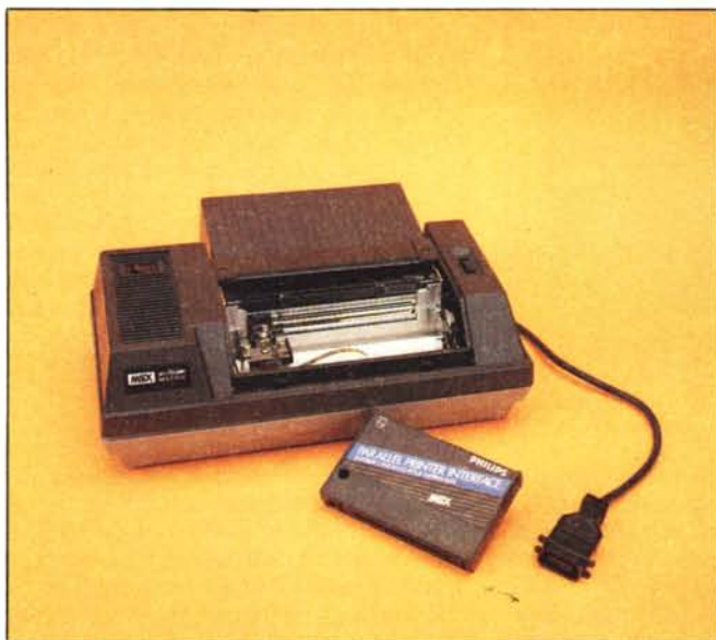
La stampantina a 40 colonne (e la cartuccia d'interfaccia). Il metodo di stampa è ad impatto.
