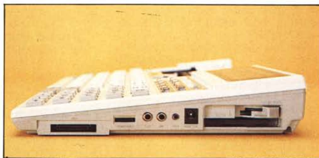
Vista laterale destra. Su questo lato sono situati tutti i connettori relativi ad espansione ed I/O del PC-2500
