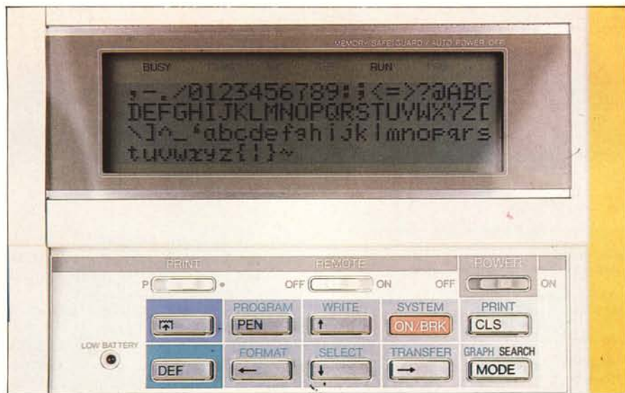
Particolare del display e del tastierino-funzioni dedicato al Business Software. Sul visualizzatore è presente tutto il set di caratteri.
