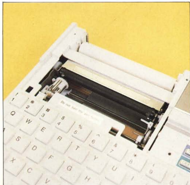
Vista esterna e particolare interno del mini-plotter a quattro colori del PC-2500.
