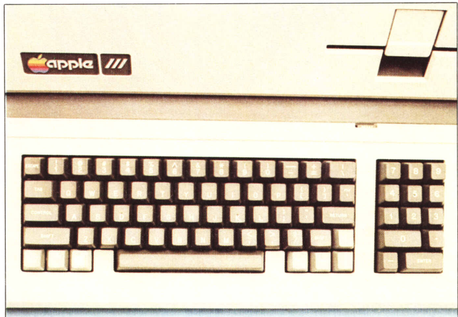
La tastiera dell'Apple III è di 74 tasti: 61 per la tastiera principale e 13 per la tastiera numerica. Tutti i tasti hanno l'Auto Repeat ed un "tocco" leggero e "professionale". A differenza dell'Apple II sono accessibili tutti i 128 caratteri ASCII direttamente dalla tastiera ed inoltre, spingendo contemporaneamente il tasto con la mela aperta, viene settato l'ottavo bit del codice ASCII relativo ad ognuno dei 128 caratteri principali in modo da avere 256 codici possibili dalla tastiera. In pratica vuol dire che sotto programma si possono definire 128 tasti speciali!
