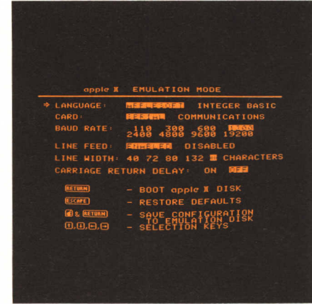
Il menu dell'Apple II Emulator permette la scelta tra Applesoft o Integer BASIC, scheda Seriale o Communication, BAUD rate e larghezza di stampa.
