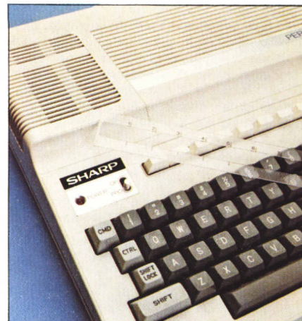
Un particolare del commutatore OP/PRO (Operator/Programmer) descritto nel testo; notare anche la mascherina di plastica su cui è possibile annotare i contenuti dei tasti definibili.
