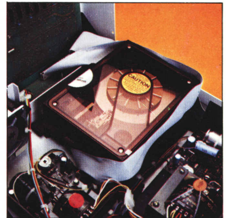
Un particolare del winchester da 5" 1/4, nel suo contenitore a tenuta d'aria.
