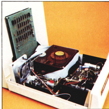
L'interno del Corvus. Si notano chiaramente il winchester, la ventola di raffreddamento e, montata sul coperchio, la scheda Mirror, ossia l'interfaccia per il backup su videoregistratore.
