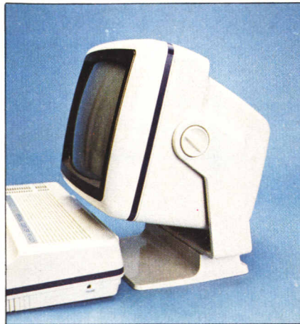
Il supporto del monitor, orientabile, è al tempo stesso, esteticamente piacevole, stabile e razionale. Permette, tra l'altro, di collocare il video dietro la macchina senza problemi di altezza.
