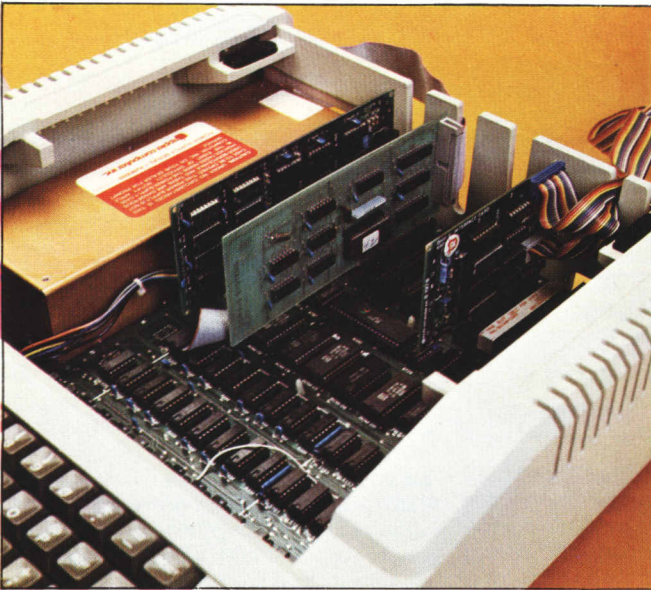
Come vanno configurate le schede durante la fase di formattamento del Corvus. Da sinistra: Language Card (slot 0), il controller del Corvus (slot 2) e il controller dei minifloppy (slot 6).
